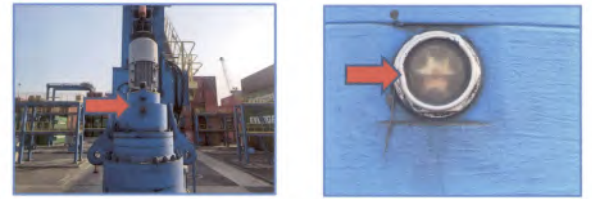
RTG 002 วันที่ 25 มกราคม 2568 ตรวจเช็คน้ำมันเกียร์รถล้อ จำนวน 4 ลูก
