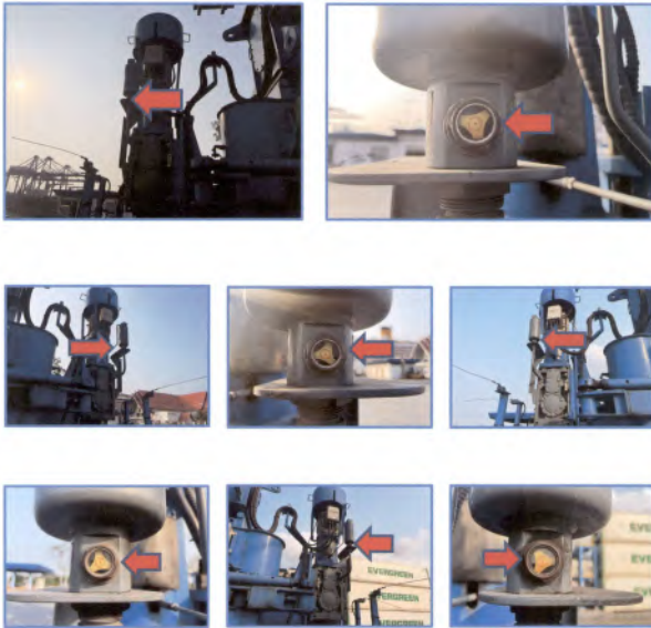
RTG 003 วันที่ 19 กุมภาพันธ์ 2568 ตรวจเช็คน้ำมันเกียร์ Gantry จำนวน 4 ลูก
