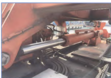
MHC 01 วันที่ 29 พฤษภาคม 2568 ตรวจเช็คกระบอกไฮดรอลิก Spreader
