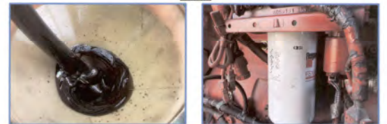
RTG 002 วันที่ 25 กุมภาพันธ์ 2568 ตรวจสอบภาพ 1000 ชั่วโมง เปลี่ยนถ่ายน้ำมันเครื่อง ก่อนทำ
