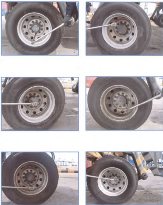
MHC 01 วันที่ 29 พฤษภาคม 2568 ตรวจสอบความหนาแน่นของสกรูระบบ Traveling
