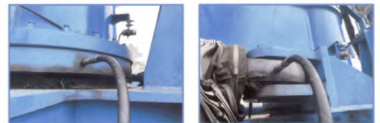
RTG 003 วันที่ 25 กุมภาพันธ์ 2568 อัดจารบีระบบ Gantry
