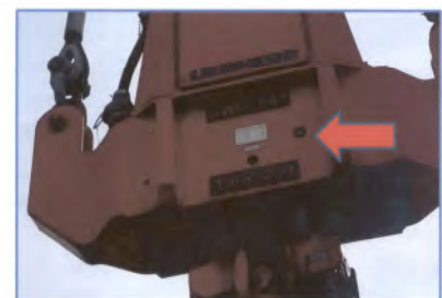
MHC 01 วันที่ 29 พฤษภาคม 2568 ตรวจเช็คน้ำมันไฮดรอลิกมอเตอร์ Rotator
