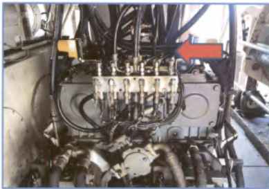
MHC 01 วันที่ 29 พฤษภาคม 2568 ตรวจเช็คน้ำมันเกียร์ Distribution Gearbox
