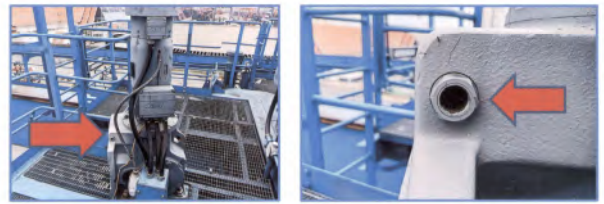
RTG 003 วันที่ 25 กุมภาพันธ์ 2568 ตรวจเช็คน้ำมันเกียร์ Skew จำนวน 4 ลูก
