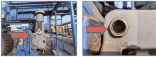
RTG 002 วันที่ 25 มกราคม 2568 ตรวจเช็คน้ำมันเกียร์ Gantry จำนวน 4 ลูก
