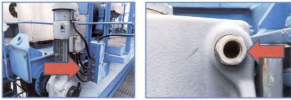
RTG 003 วันที่ 25 กุมภาพันธ์ 2568 ตรวจเช็คน้ำมันเกียร์ Trolley จำนวน 4 ลูก
