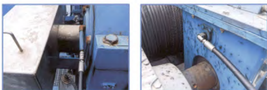
RTG 003 วันที่ 25 กุมภาพันธ์ 2568 อัดจารบีระบบ Hoist
