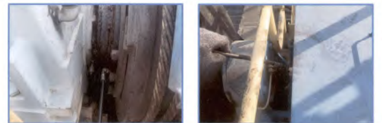
RTG 002 วันที่ 7 มกราคม 2568 อัดจารบีระบบ Hoist
