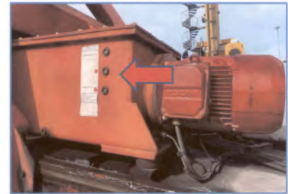
MHC 01 วันที่ 29 พฤษภาคม 2568 ตรวจเช็คน้ำมันไฮดรอลิก Spreader
