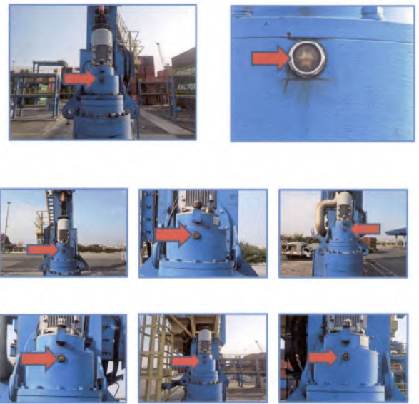
RTG 002 วันที่ 31 มกราคม 2568 ตรวจเช็คน้ำมันเกียร์ล้อขับเคลื่อน จำนวน 4 ลูก
