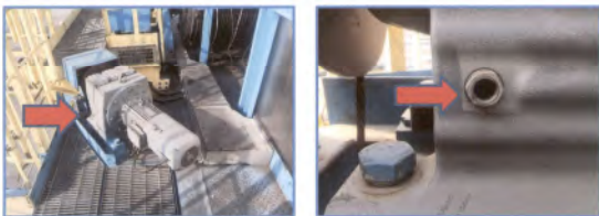
RTG 002 วันที่ 25 มกราคม 2568 ตรวจเช็คน้ำมันเกียร์ Skew จำนวน 4 ลูก
