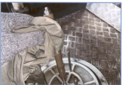
MHC 01 วันที่ 29 พฤษภาคม 2568 ทำความสะอาดถังแม่เหล็กใน Return Filter
